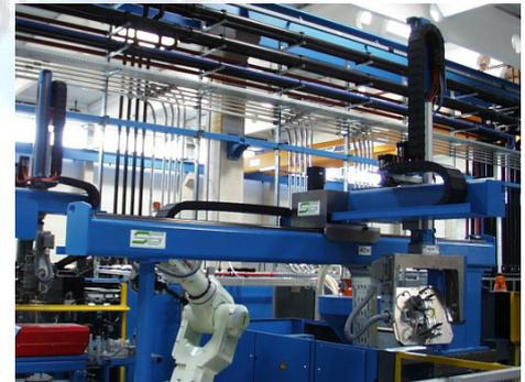
Die Ablaufprogrammierung erfolgt im „TEACH-IN“ Verfahren und ist vom Kunden problemlos durchzuführen. Eine digitale Schnittstelle ermöglicht eine übersichtliche Kommunikation mit Fremdgeräten (z.B. Spritzgießanlagen).
