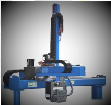
bieten die erforderlichen Freiheitsgrade für den Greifer und werden üblicherweise auch als Servoachsen ausgeführt.
