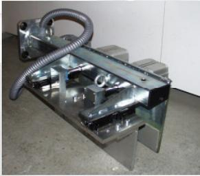
Unsere Greifer werden speziell nach den jeweils gegebenen Anforderungen konstruiert, gefertigt und getestet. Dabei übernehmen die Greifer mitunter auch Zusatzfunktionen wie etwa die Erfassung extern einwirkender Kräfte und Momente, oder zusätzliche Verschiebe- bzw. Trennfunktionen. Die
