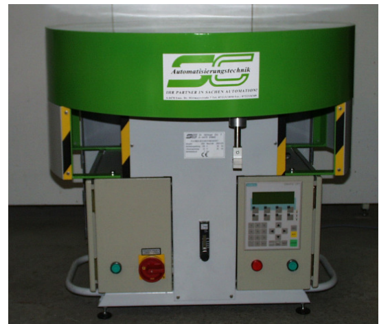
Wickelmaschine zur Herstellung flach gewickelter Drahtscheiben
