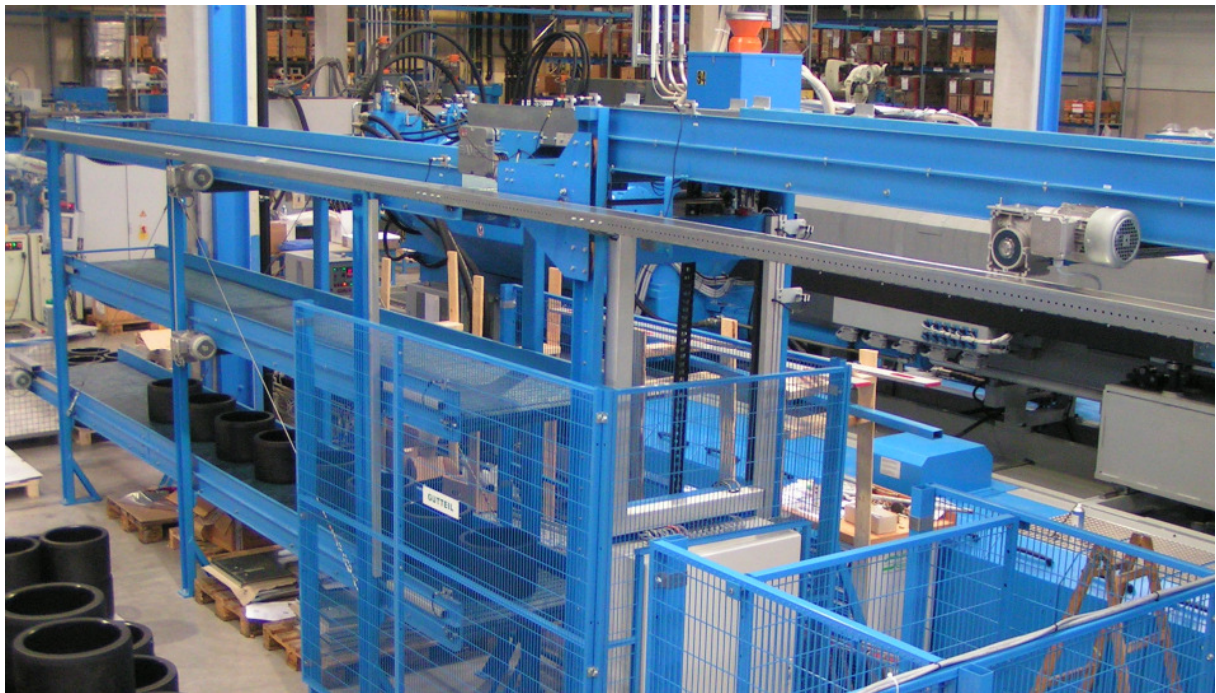
Förderbandspeicher mit drei Speicherbändern, Zuführband und Hublift.
