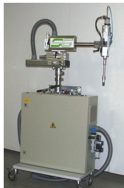
Wickelmaschine zur Herstellung flach gewickelter Drahtscheiben
