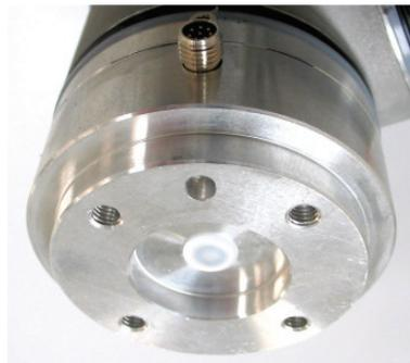
An der Werkzeugseite des Roboters gibt es einen kleinen Stecker mit acht Anschlüssen.
