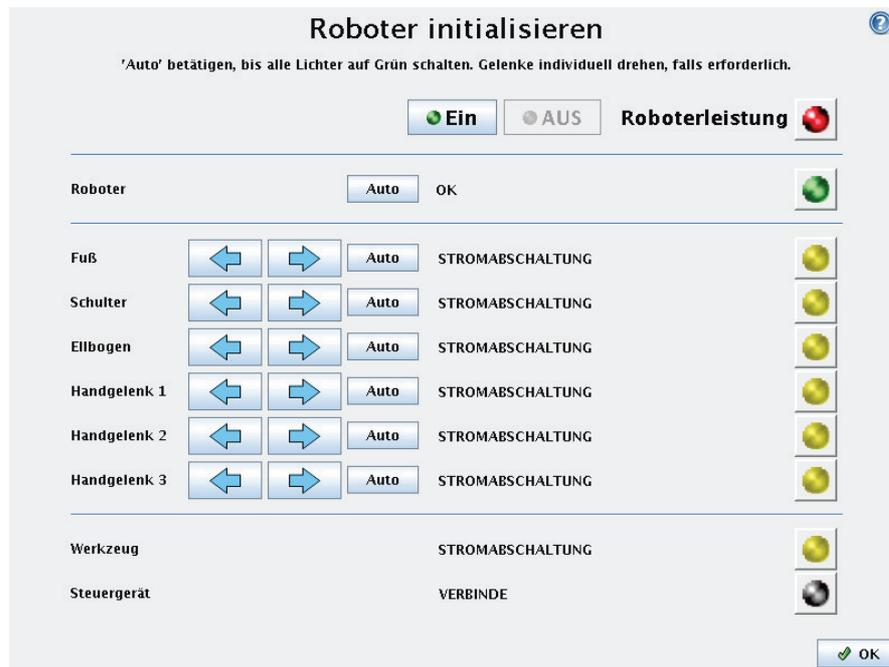
Mit diesem Bildschirm steuern Sie die Initialisierung des Roboters. Wenn der Roboter eingeschaltet ist, muss er die Positionen jedes Gelenks finden. Um die Gelenkpositionen zu erhalten, muss der Roboter jedes Gelenk bewegen.
