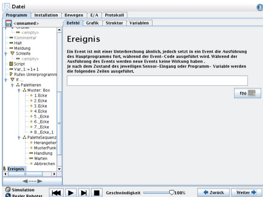
Ein Ereignis kann zur Überwachung eines Eingangssignals eingesetzt werden und eine Maßnahme durchführen oder eine Variable einstellen, wenn dieses
