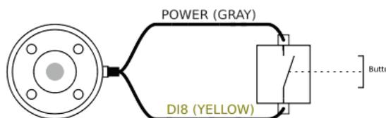
Das oben stehende Beispiel zeigt den Anschluss eines einfachen Tasters oder Schalters.
