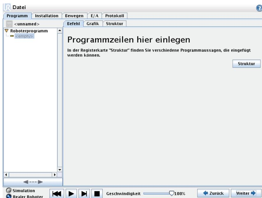
Programmbefehle müssen hier eingegeben werden. Drücken Sie auf die Schaltfläche "Structure", um zur Registerkarte Structure zu gelangen, in der die verschiedenen auswählbaren Programmzeilen zu finden sind. Ein Programm kann erst ausgeführt werden, wenn alle Zeilen vorgegeben und festgelegt sind.
