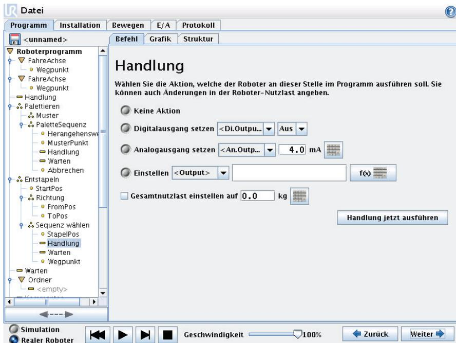
Setzt entweder digitale oder analoge Ausgänge auf einen vorgegebenen Wert. Kann ebenfalls zur Einstellung der Tragfähigkeit des Roboters eingesetzt werden, beispielsweise das Gewicht, das durch diese Maßnahme aufgenommen wird. Die Einstellung des Gewichtes kann notwendig sein, um zu verhindern, dass der Roboter aus Gründen der Sicherheit plötzlich anhält, wenn sich das Gewicht am Werkzeug vom erwarteten Gewicht unterscheidet.
