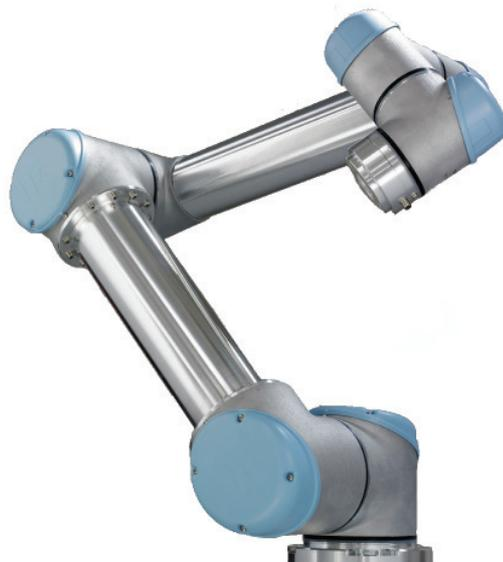
Der Roboter ist eine Maschine, die zur Bewegung eines Werkzeuges programmiert werden kann und die mit anderen Maschinen über elektrische Signale kommunizieren kann. Über unsere patentierte Programmieroberfläche, PolyScope, ist die Programmierung des Roboters zur Bewegung eines Werkzeuges entlang eines gewünschten Weges einfach. Eine Beschreibung zu PolyScope finden Sie in Abschnitt 3.1.
