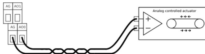
Hierbei handelt es sich um die normale und beste Art und Weise der Verwendung analoger Ausgänge. Die Abbildung zeigt einen Aufbau, bei dem das Steuergerät des Roboters einen Stellmotor steuert, z. B. ein Förderband. Das beste Ergebnis wird im Strommodus erzielt, da dieser unempfindlicher gegenüber Störsignalen ist.
