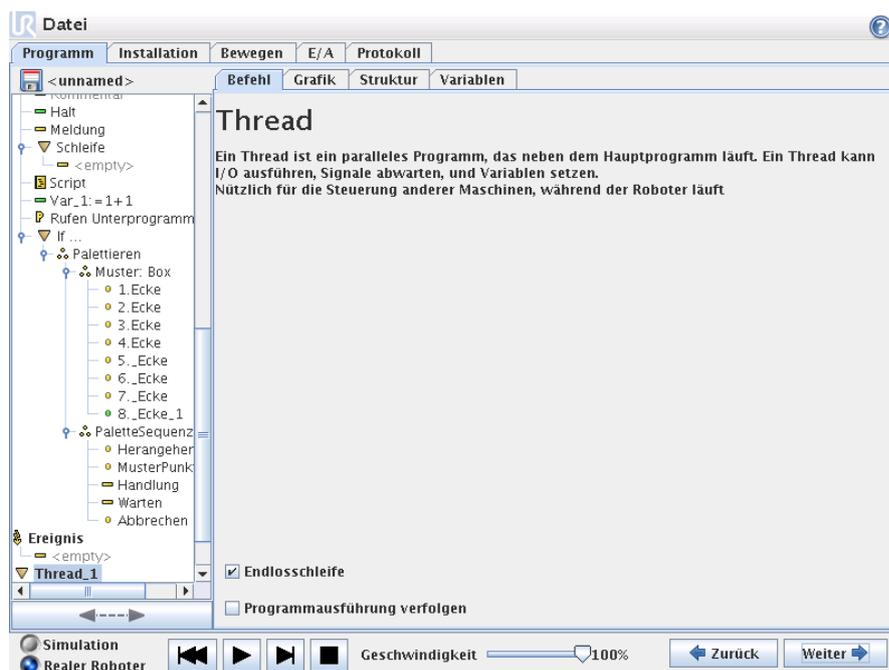
Ein Thread ist ein paralleler Prozess zum Roboterprogramm. Ein Thread kann zur Steuerung einer externen Maschine, unabhängig vom Roboterarm, eingesetzt werden. Ein Thread kann mit Hilfe von Variablen und Ausgangssignalen mit dem Roboterprogramm kommunizieren.
