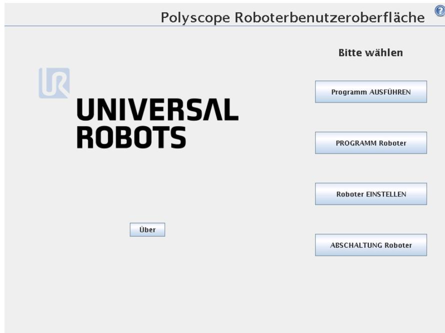
Die oben stehende Abbildung zeigt den Startbildschirm. Die bläulichen Bereiche des Bildschirms sind Schaltflächen, die mit dem Finger oder der Rückseite eines Stiftes betätigt werden können. PolyScope verfügt über eine hierarchische Bildschirmstruktur. In der Programmierumgebung sind die Bildschirme für einen leichten Zugang zu den Bildschirmen in *Registerkarten* angeordnet.
