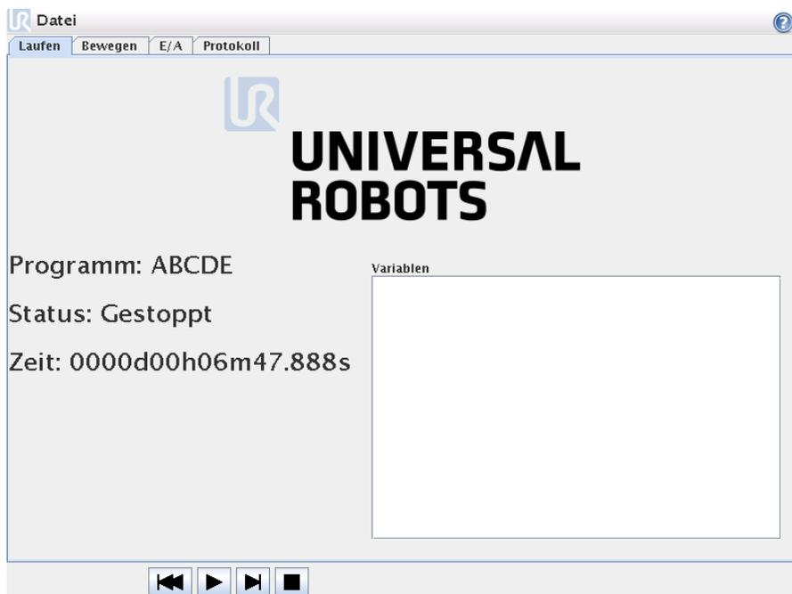
Diese Registerkarte bietet einen sehr einfachen Weg zur Bedienung des Roboters, mit so wenig Schaltflächen und Optionen wie möglich. Dies kann sinnvoll mit einem Passwort kombiniert werden, das den Programmiererteil von PolyScope schützt (siehe Abschnitt 3.5.5), um den Roboter zu einem Werkzeug zu machen, das ausschließlich vorher geschriebene Programme ausführt.
