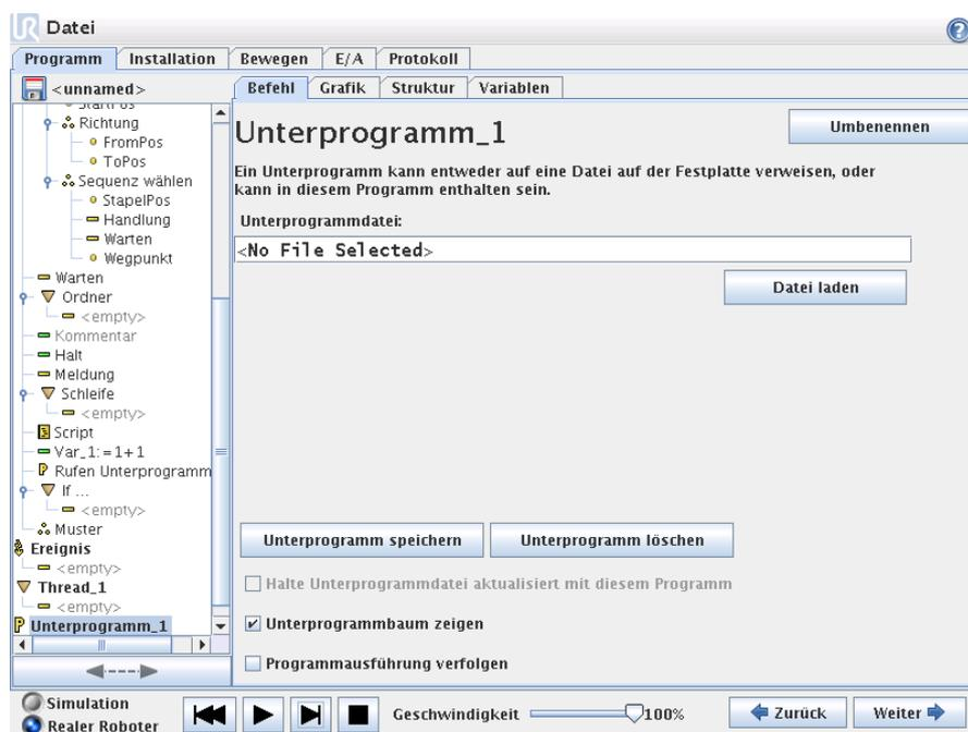
Ein Unterprogramm kann Programmteile enthalten, die an mehreren Stellen erforderlich sind. Ein Unterprogramm kann eine separate Datei auf der Diskette und kann auch versteckt sein, um sie gegen ungewollte Änderungen am Unterprogramm zu schützen.
