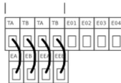
Bei der einfachsten Konfiguration wird die interne Not-Aus-Taste als einzige Komponente für eine Notabschaltung eingesetzt. Dies wird mit oben gezeigter Konfiguration erreicht. Diese Konfiguration ist standardmäßig ab Werk eingestellt, so dass der Roboter betriebsbereit ist. Wenn die Risikobewertung dies erfordert, sollte die Not-Aus-Konfiguration jedoch geändert werden.
