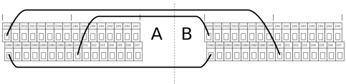
Sofern eine Kommunikation mit anderen Maschinen oder SPS erforderlich ist, müssen diese **pnp**-Technologie einsetzen. Denken Sie daran, dass sie eine gemeinsame Erdungsverbindung zwischen den verschiedenen Schnittstellen herstellen. Oben stehend finden Sie ein Beispiel, in dem zwei UR-Roboter (A und B) miteinander kommunizieren.
