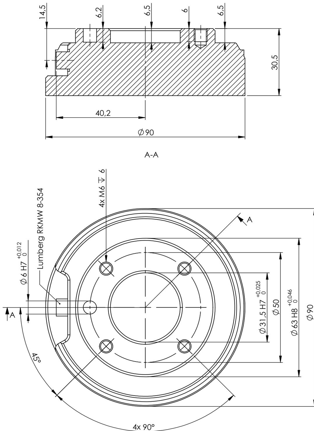
**Abbildung 1.4:** Der Werkzeugflansch, ISO 9409-1-50-4-M6. Hier wird das Werkzeug an die Spitze des Roboters montiert. Alle Maßangaben in *mm*.
