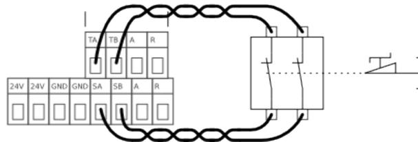
Der Anschluss eines Türschalters o. Ä. erfolgt wie oben gezeigt. Denken Sie daran, eine Reset-Tasten-Konfiguration zu wählen, wenn der Roboter beim Schließen der Tür nicht automatisch anlaufen soll.
