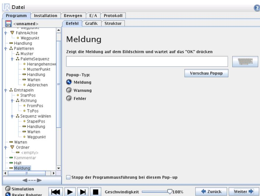
Eine Meldung ist ein Pop-up, das auf dem Bildschirm angezeigt wird, wenn das Programm diesen Befehl erreicht. Der Stil der Meldung ist wählbar und der Text kann mit Hilfe der Tastatur auf dem Bildschirm vorgegeben werden. Der
