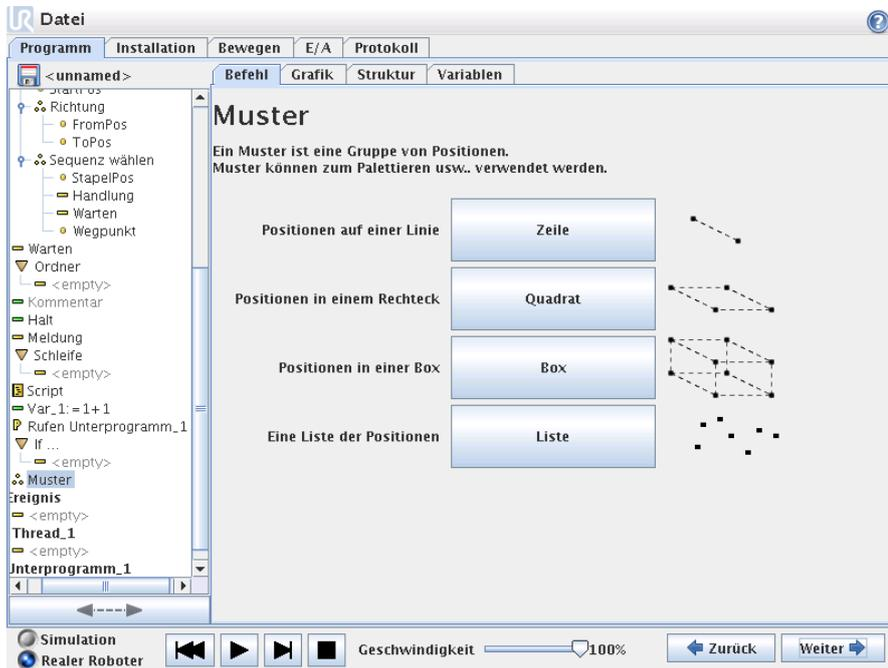
Der Befehl Muster kann eingesetzt werden, um die Positionen im Roboterprogramm durchzulaufen. Der Befehl Muster entspricht bei jeder Ausführung einer Position.
