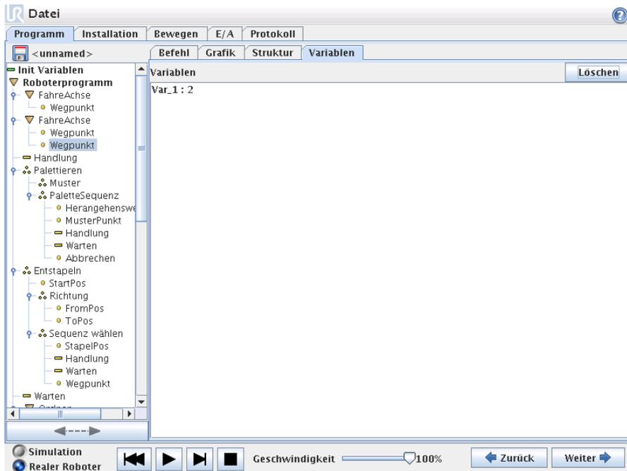
Die Registerkarte, Variablen, zeigt die Live-Werte der Variablen in das laufende Programm und führt eine Liste von Variablen und Werte zwischen Programmverläufe. Die Registerkarte, Variablen, erscheint nur, wenn sie Informationen angezeigt hat.
