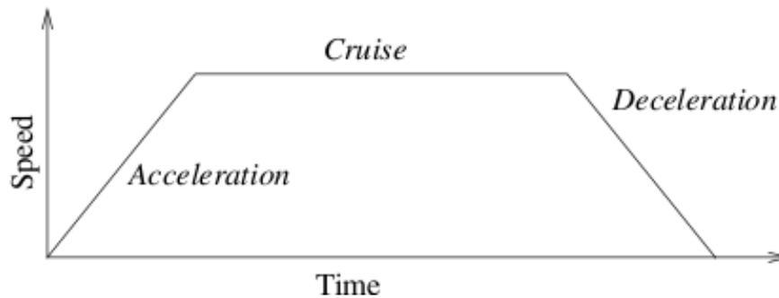
**Abbildung 3.1:** Geschwindigkeitsprofil für eine Bewegung. Die Kurve wird in drei Segmente unterteilt: Beschleunigung *acceleration*, gleichbleibend *cruise* und Verzögerung *deceleration*. Die Höhe der Phase *cruise* wird durch die Geschwindigkeitseinstellung der Bewegung vorgegeben, während die Steilheit der Phasen *acceleration* und *deceleration* durch den Beschleunigungsparameter vorgegeben wird.
