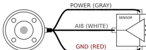
Die einfachste Art und Weise zur Verwendung analoger Eingänge. Der Ausgang des Sensors kann entweder Strom oder Spannung sein, solange der Eingangsmodus dieses analogen Eingangs auf der Registerkarte E/A entsprechend eingestellt ist (siehe Abschnitt 3.3.2). Bitte denken Sie daran, zu prüfen, dass der Sensor mit Spannungsausgang den internen Widerstand des Werkzeugs antreiben kann. Andernfalls kann die Messung ungültig sein.
