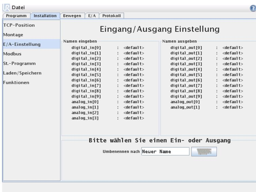
Eingangs- und Ausgangssignale können Namen gegeben werden. Somit sieht man einfacher wofür das Signal verwendet wird. Wählen Sie einen E / A indem Sie darauf klicken, und legen Sie den Namen über die Tastatur auf dem Bildschirm. Sie können den Namen zurücksetzen, indem Sie nur Leerzeichen einsetzen.
