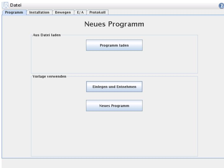
Ein neues Roboterprogramm kann entweder von einer *Vorlage* oder von einem vorhandenen (gespeicherten) Roboterprogramm gestartet werden. Eine *Vorlage* kann die Gesamtprogrammstruktur bieten, so dass nur die Details des Programms ausgefüllt werden müssen.
