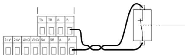
Den Anschluss einer Reset-Taste sehen Sie oben stehend. Eine permanent betätigte Reset-Taste ist unzulässig. Wenn die Reset-Taste betätigt ist, erfolgt ein Schutz-Aus und eine Fehlermeldung erscheint auf dem Bildschirm.
