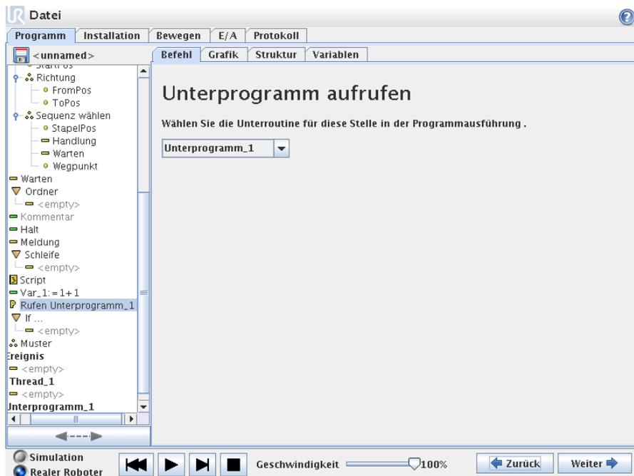
Wenn Sie ein Unterprogramm aufrufen, werden die Programmzeilen im Unterprogramm ausgeführt, und anschließend geht es in der nächsten Zeile weiter.
