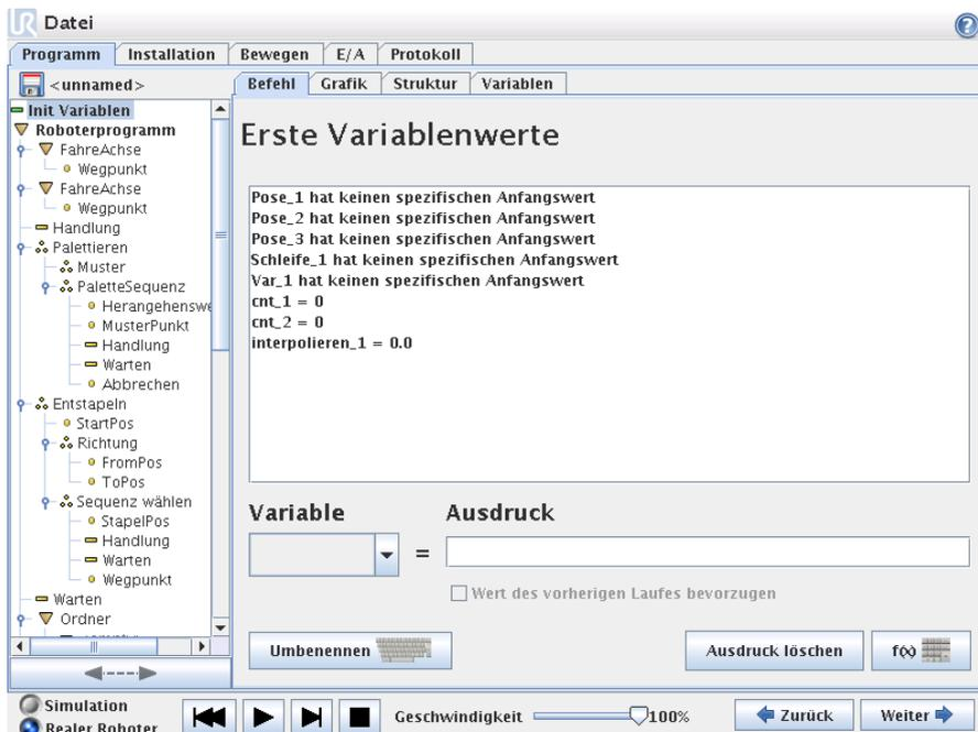
Dieser Bildschirm ermöglicht die Einstellung variabler Werte, bevor das Programm (und alle Faden) ausgeführt wird.
