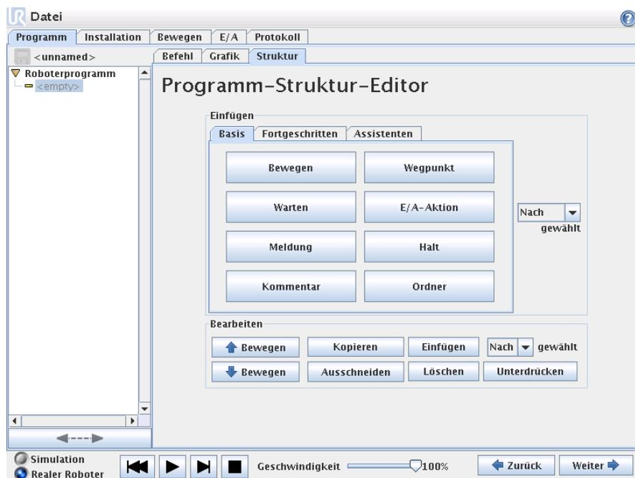
Auf der Registerkarte Struktur kann man die verschiedenen Befehlsarten einfügen, verschieben, kopieren und/oder entfernen.
