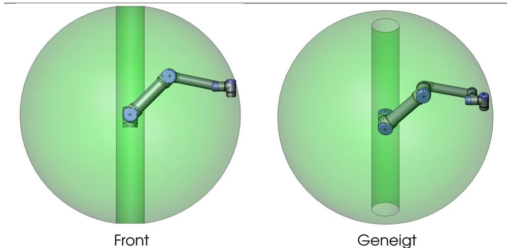
**Abbildung 1.2:** Der Arbeitsbereich des Roboters. Der Roboter kann um das Unterteil in einem ungefähren Raum von ( $\varnothing$  170 cm) arbeiten, mit Ausnahme eines zylindrischen Volumens direkt über und direkt unter dem Roboterunterteil.
