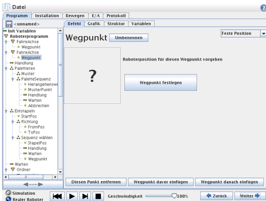
Ein Punkt entlang des Weges des Roboters. Wegpunkte sind der wichtigste Teil eines Roboterprogramms, denn durch sie weiß der Roboter wo er sein muss. Ein Wegpunkt mit einer festen Position wird vorgegeben, indem der Roboter physikalisch in die entsprechende Position bewegt wird.
