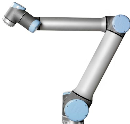
Der Roboter ist eine Maschine, die zur Bewegung eines Werkzeuges programmiert werden kann und die mit anderen Maschinen über elektrische Signale kommunizieren kann. Über unsere patentierte Programmieroberfläche, PolyScope, ist die Programmierung des Roboters zur Bewegung eines Werkzeuges entlang eines gewünschten Weges einfach. Eine Beschreibung zu PolyScope finden Sie in Abschnitt 3.1.
