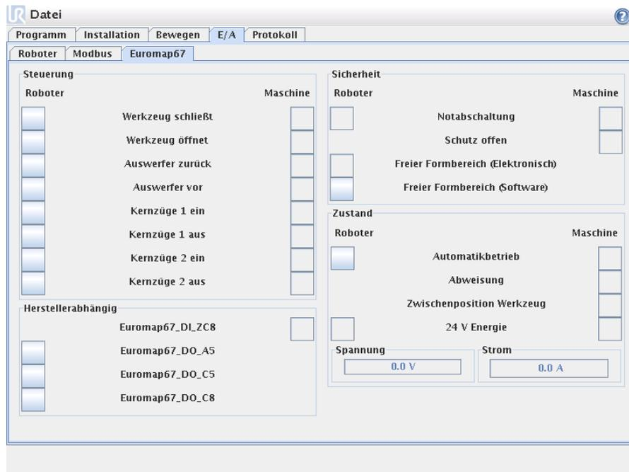
Es gibt vier Rahmen auf dem Bildschirm, die unten stehend beschrieben sind. Allen gemeinsam sind die beiden Spalten *Roboter* und *Maschine*, die jeweils Schaltflächen zur Steuerung der Ausgangssignale und Anzeigen zur Anzeige des Zustandes der Eingangssignale umfassen.
