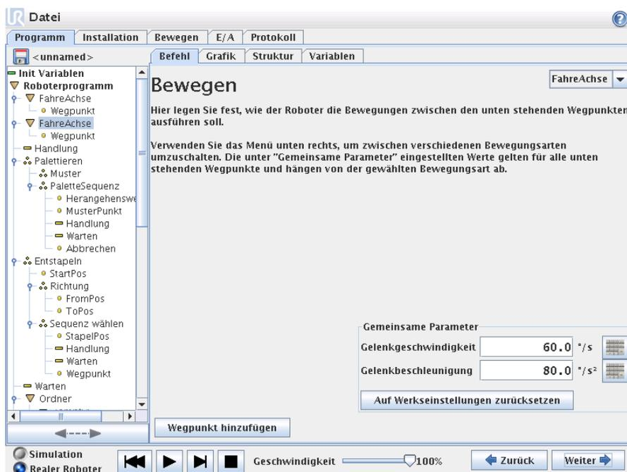
Der Befehl **Bewegen** steuert die Roboterbewegung durch die zugrunde liegenden Wegpunkte. Wegpunkte müssen unter einem **Bewegen**-Befehl vorhanden sein. Der **Bewegen**-Befehl definiert die Beschleunigung und die Geschwindigkeit, mit denen sich der Roboter zwischen diesen Wegpunkten bewegen wird.
