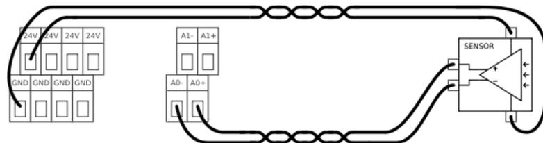
Die einfachste Art und Weise zur Verwendung analoger Eingänge. Die abgebildete Ausrüstung, wobei es sich um einen Sensor handeln könnte, verfügt über einen Differenzialspannungsausgang.
