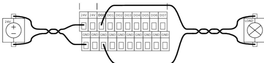
Wenn der seitens der internen Stromversorgung verfügbare Strom nicht ausreicht, verwenden Sie einfach eine externe Stromversorgung, siehe oben.
