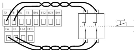
Bei beinahe jeder Roboteranwendung ist der Anschluss einer oder mehrerer externer Not-Aus-Tasten erforderlich. Dies ist einfach und leicht. Oben sehen Sie ein Beispiel für den Anschluss einer zusätzlichen Taste.
