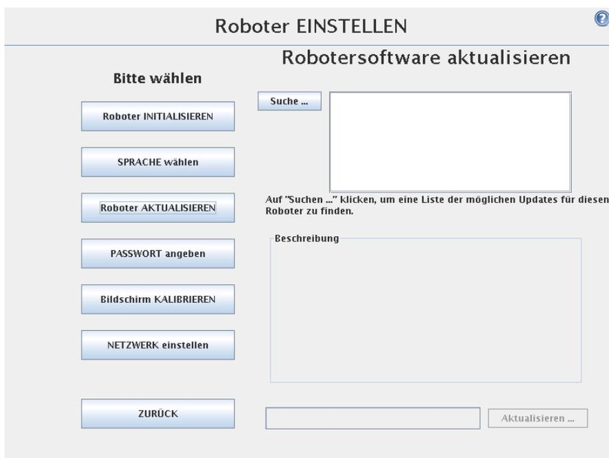
Vorausgesetzt, dass der Roboter an das Internet angeschlossen ist, kann neue Software heruntergeladen werden.
