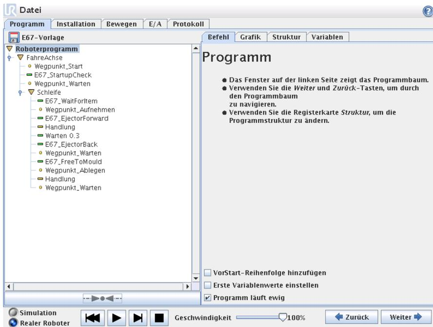
Die euromap67-Programmervorlage ist für die Durchführung der einfachen Interaktion mit einer IMM ausgelegt. Durch die Vorgabe weniger Wegpunkte und einiger E/A-Aktionen ist der Roboter in der Lage, die in der IMM hergestellten Gegenstände umzuschlagen. Die Wegpunkte lauten:
