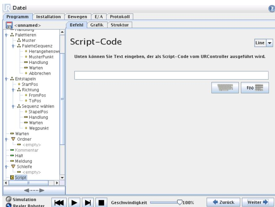
Dieser Befehl ermöglicht den Zugang zur zugrunde liegenden Echtzeitskriptsprache, die vom Steuergerät des Roboters ausgeführt wird. Dieser Punkt ist nur für fortgeschrittene Benutzer konzipiert.
