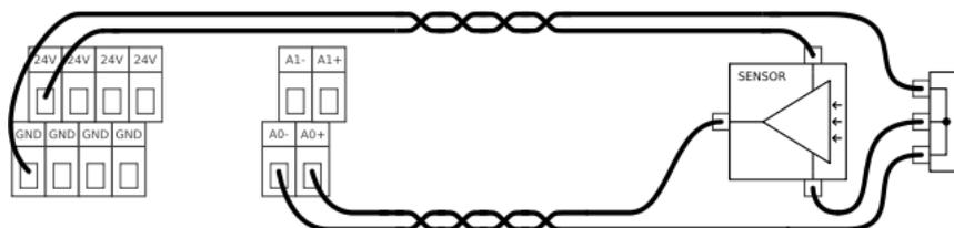
Wenn es nicht möglich ist, ein Differenzialsignal von den verwendeten Geräten zu erhalten, könnte eine Lösung wie oben stehender Aufbau aussehen. Im Gegensatz zum Beispiel für einen nicht differenzierenden analogen Ausgang in Unterabschnitt 2.4.3, wäre diese Lösung beinahe so gut wie die Differenziallösungen.
