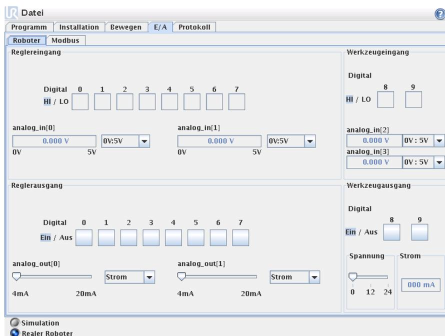
In diesem Bildschirm können Sie die spannungsführenden E-/A-Signale vom/zum Roboter stets überwachen und einstellen. Der Bildschirm zeigt den aktuellen Zustand der Ein- und Ausgänge an, einschließlich während der Programmausführung.
