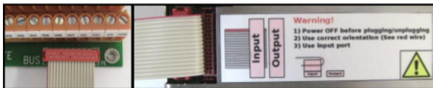
HINWEIS: Verbinden/Trennen Sie das Flachkabel **nicht** unter Strom mit dem/vom Steuergerät!
