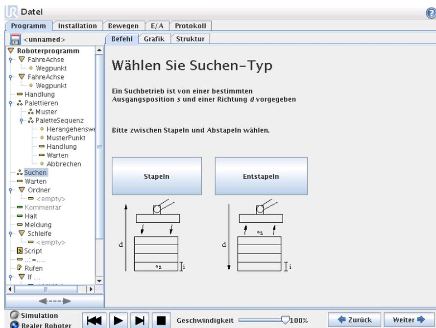
Beim Stapeln bewegt sich der Roboter in die Ausgangsposition und dann gegen die Richtung um die nächste Stapel-Position zu suchen. Wenn gefunden, merkt sich der Roboter die Position und führt die spezielle Abfolge aus. Das nächste Mal startet der Roboter die Suche aus dieser Position, erweitert mit der Dicke des Elements in der Stapelrichtung. Das Stapeln ist beendet, wenn die Stapelhöhe eine bestimmte Anzahl erreicht, oder wenn ein Sensor ein Signal gibt.
