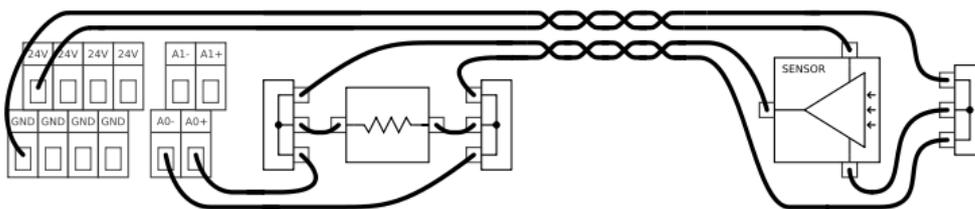
Wenn es sich beim Geräteausgang um ein nicht differenzierendes Stromsignal handelt, muss ein Widerstand wie oben gezeigt eingesetzt werden. Der Widerstand sollte bei circa 200 Ohm liegen und die Beziehung zwischen der Spannung am Eingang des Steuergerätes und am Ausgang des Sensors wird durch Folgendes vorgegeben:
