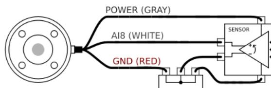
Die Verwendung von Sensoren mit Differenzialausgängen ist ebenfalls unkompliziert. Verbinden Sie einfach den negativen Teil des Ausgangs mit der Erdung (0 V) über eine Klemmenleiste und die Funktionsweise gleicht der eines nicht differenzierenden Sensors.
