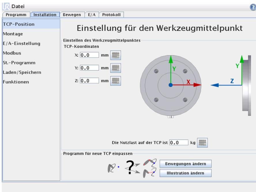
Der *Werkzeugmittelpunkt* (TCP) ist der Punkt am Ende des Roboterarms, der einen charakteristischen Punkt auf dem Roboterwerkzeug ergibt. Wenn sich der Roboter linear bewegt, bewegt sich dieser Punkt auf einer geraden Linie. Darüber hinaus ist die Bewegung des TCP in der Registerkarte Graphics visualisiert. Der TCP wird bezogen auf die Mitte des Werkzeugausgangsflansches angegeben, siehe Informationen auf den Bildschirmgrafiken.
