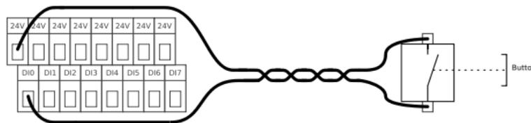
Das oben stehende Beispiel zeigt den Anschluss eines einfachen Tasters oder Schalters.
