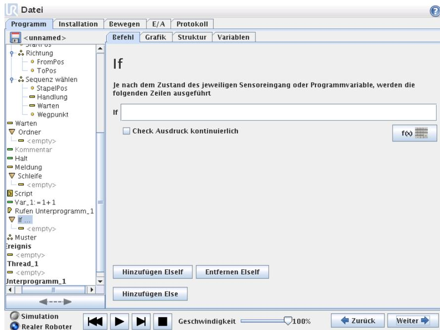
Eine “Wenn..dann..sonst” Struktur kann den Roboter sein Verhalten aufgrund von Sensoreingängen oder Variablenwerten ändern lassen. Verwenden Sie den Ausdrucksektor, um die Bedingung zu beschreiben, in der der Roboter mit den Unterbefehlen dieses `If` fortfahren soll. Wenn die Bedingung für `True` bewertet wird, werden die Zeilen in diesem `If` ausgeführt.
