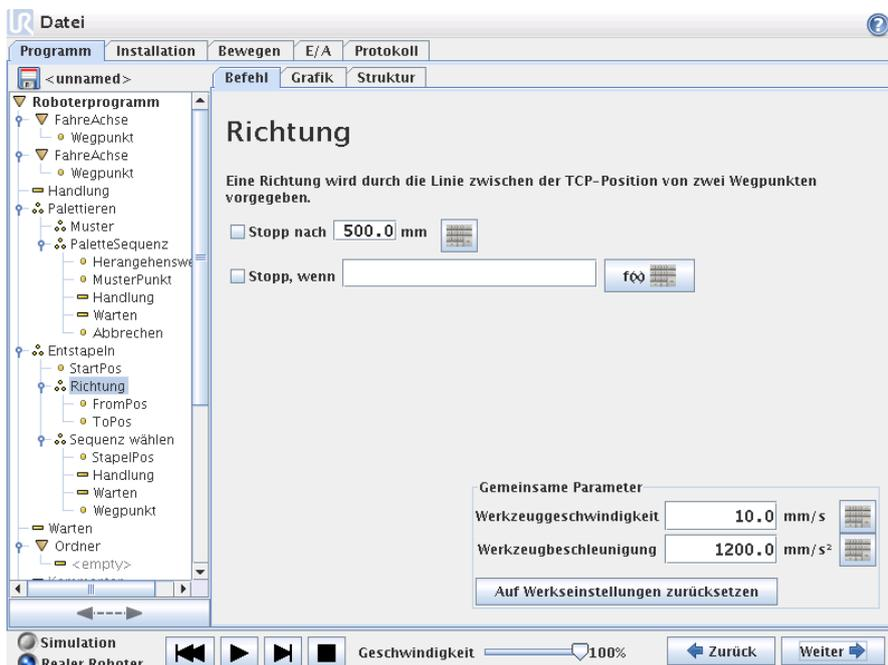
Die Richtung wird durch zwei Punkte angezeigt und ist als Differenz aus der ersten TCP Punkt zu einem anderen Punkt TCP berechnet. Hinweis: Eine Richtung berücksichtigt nicht die Orientierung der Punkte.
