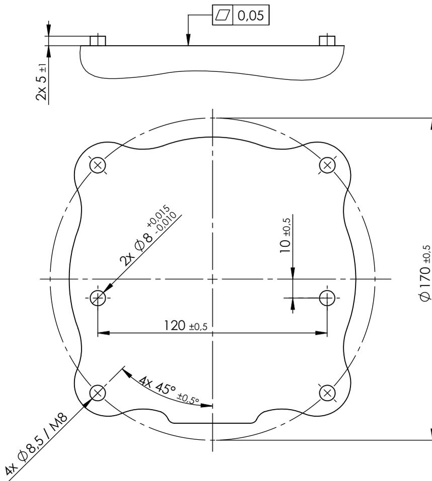
**Abbildung 1.3:** Löcher zur Montage des Roboters, Maßstab 1:2. Verwenden Sie 4 M8-Schrauben. Alle Maßangaben in *mm*.
