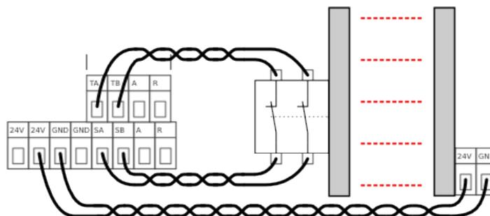
Den Anschluss eines Lichtgitters sehen Sie oben stehend. Ein Lichtgitter der Klasse 1 (ISO 13849-1 und EN 954-1) kann ebenfalls eingesetzt werden, sofern die Risikobewertung dies erlaubt. Beim Anschluss eines Lichtgitters der Klasse 1 müssen Sie TA und SA verwenden und TB und SB mit einem Draht überbrücken. Denken Sie daran, eine Reset-Tasten-Konfiguration zu verwenden, so dass der Schutz-Aus einrastet.
