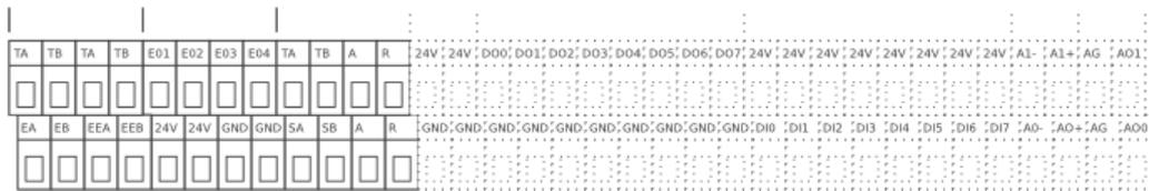
Im Steuergerät gibt es eine Schraubklemmenleiste. Die Sicherheitsschnittstelle befindet sich ganz links, schwarzer Teil der Abbildung. Über die Sicherheitsschnittstelle kann der Roboter an andere Maschinen oder Schutzgeräte angeschlossen werden, um sicherzustellen, dass er in bestimmten Situationen anhält.
