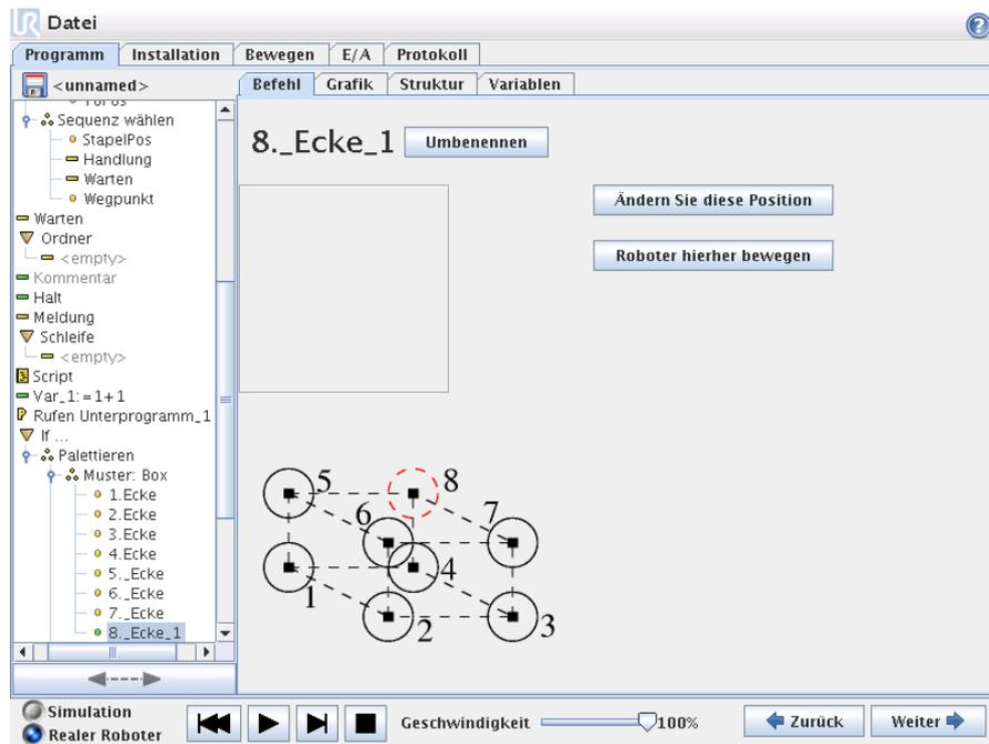
Ein "BoxMuster verwendet drei Vektoren um die Seite des Boxes zu definieren. Diese drei Vektoren sind als vier Punkte gegeben, wo der erste Vektor geht vom Punkt ein bis zwei, der zweite vom Punkt zwei bis drei, und der dritte geht von Punkt drei bis vier. Jeder Vektor wird durch die Anzahl der Punkte in dem angegebenen Intervall dividiert. Jede Position im Muster wird durch das proportionale Addieren der Intervektoren berechnet.
