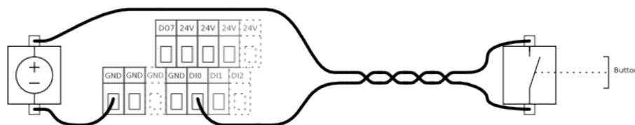
Das oben stehende Beispiel zeigt den Anschluss eines Tasters mit Hilfe einer externen Stromquelle.
