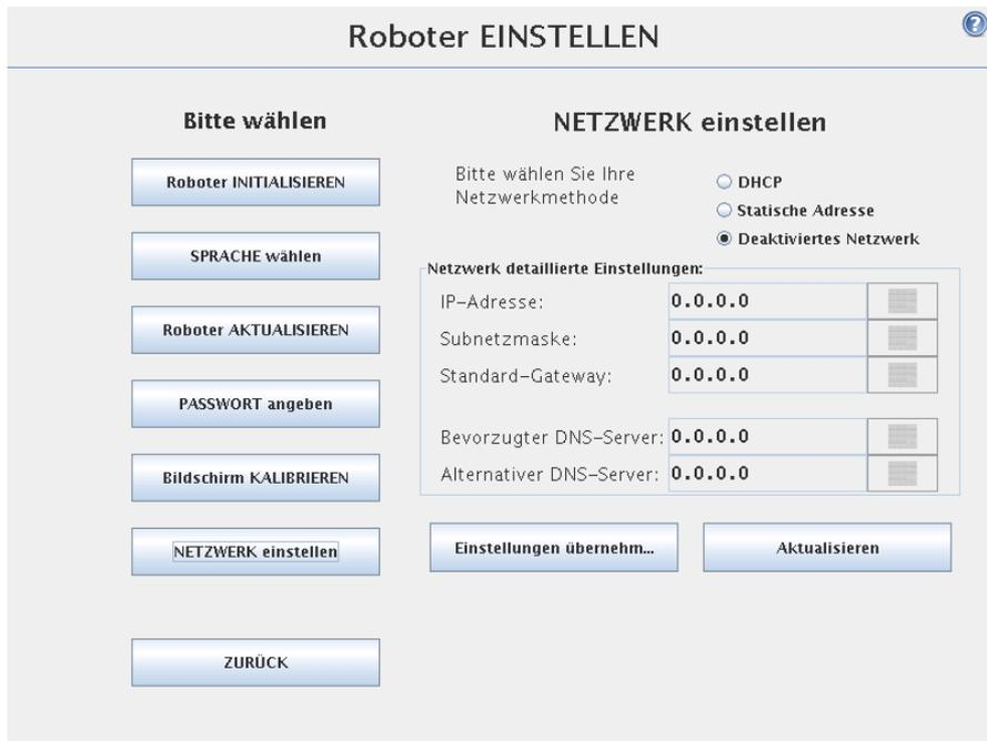
Feld zur Einrichtung des Ethernet-Netzwerkes. Für die grundlegenden Roboterfunktion ist keine Ethernet-Verbindung erforderlich, so dass diese standardmäßig deaktiviert ist.
