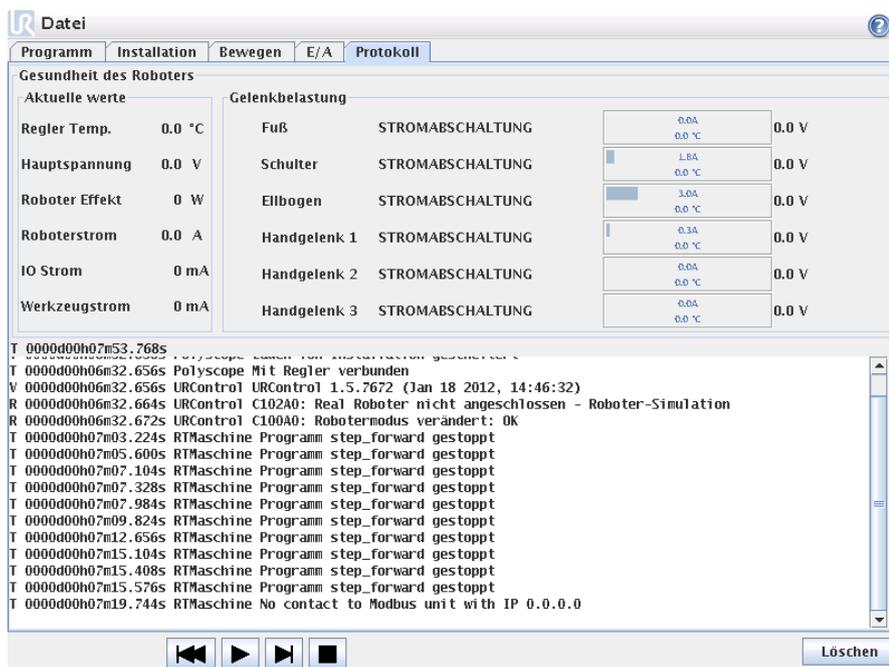
**Gesundheit des Roboters** Die obere Hälfte des Bildschirms zeigt die Gesundheit des Roboters an. Der linke Teil zeigt Informationen im Zusammenhang mit dem Steuergerät des Roboters, während der rechte Teil Informationen zu jedem Roboter-gelenk anzeigt. Jedes Roboter-gelenk zeigt Informationen über die Motortemperatur und zur Elektronik, zur Belastung des Gelenkes und zur Spannung am Gelenk.
