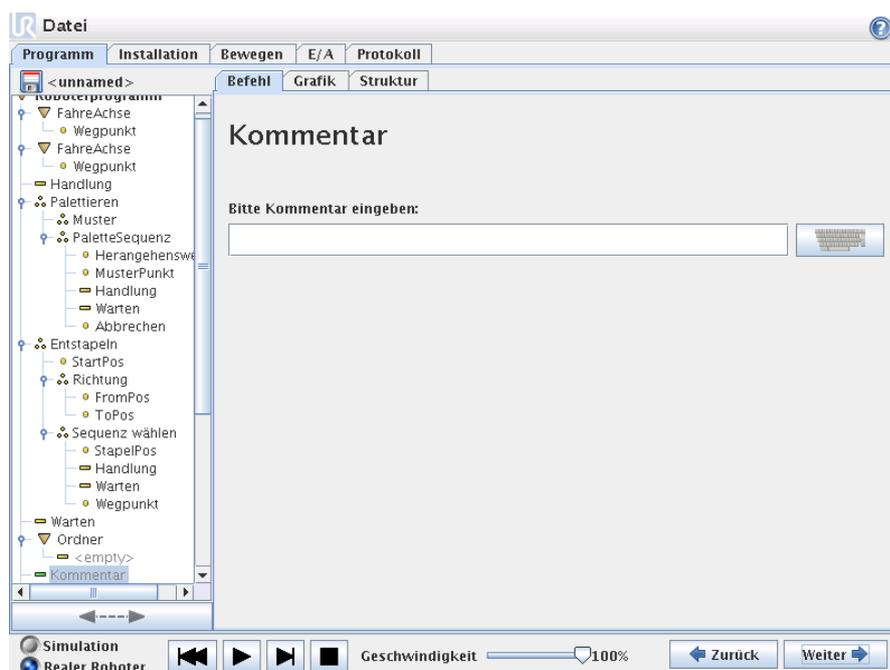
Hier erhält der Programmierer die Möglichkeit, das Programm durch eine Textzeile zu ergänzen. Diese Textzeile hat während der Ausführung des Programms keinerlei Wirkung.
