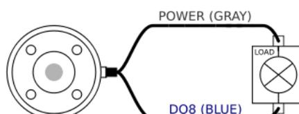
Dieses Beispiel zeigt die Aktivierung eines Verbrauchers mit Hilfe der internen 12-V- oder 24-V-Stromversorgung. Bitte bedenken Sie, dass Sie die Ausgangsspannung auf der Registerkarte E/A festlegen müssen (siehe Abschnitt 3.3.2). Bitte beachten Sie, dass zwischen dem Anschluss POWER und dem Schirm/der Erdung Spannung anliegt, auch wenn der Verbraucher ausgeschaltet ist.
