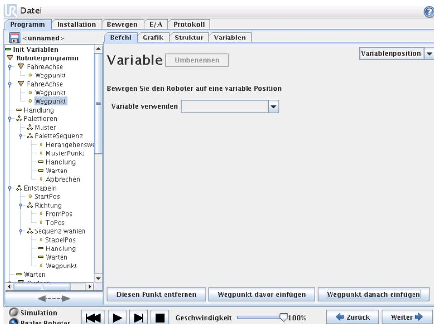
Ein Wegpunkt, dessen Position durch eine Variable angegeben wird, in diesem Fall `calculated_pos`. Die Variable muss eine *pose* sein, wie beispielsweise `var=p[0.5,0.0,0.0,3.14,0.0,0.0]`, sein.. Die ersten drei Ziffern sind *x,y,z* und die letzten drei Ziffern beschreiben die Ausrichtung als *Rotationsvektor*, der
