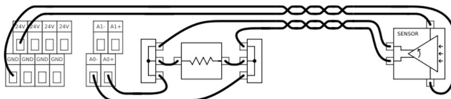
Wenn längere Kabel eingesetzt werden oder die Umgebung sehr geräuschintensiv ist, werden auf Strom basierende Signale bevorzugt. Einige Geräte werden darüber hinaus ausschließlich mit einem Stromausgang geliefert. Um den Strom als Eingang zu verwenden, wird ein externer Widerstand benötigt, siehe oben. Der Wert des Widerstandes wäre in der Regel circa 200 Ohm, wobei das beste Ergebnis erzielt wird, wenn der Widerstand in der Nähe der Schraubklemmen des Steuergerätes befestigt wird.
