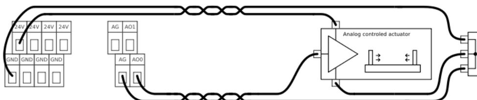
Wenn die gesteuerten Geräte keinen Differenzialeingang aufnehmen, kann eine alternative Lösung wie oben stehend umgesetzt werden. Diese Lösung ist hinsichtlich der Störanfälligkeit nicht ideal und kann Störsignale von anderen Maschinen einfach aufnehmen. Bei der Verkabelung ist vorsichtig vorzugehen und man muss sich bewusst sein, dass in analogen Ausgängen induzierte Störsignale auch bei anderen analogen Ein- und Ausgängen vorhanden sein können.
