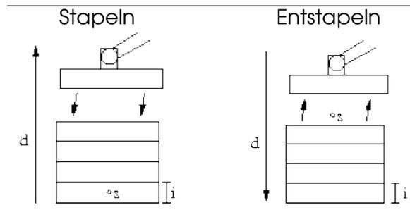
Bei der Programmierung einer Stapelvorgang, ist der Ausgangspunkt  $s$ , Die Stapelrichtung  $d$  und die Dicke der Elemente auf dem Stapel  $i$  zu definieren.
