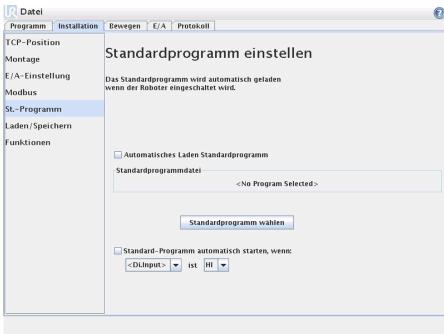
Das Standard-Programm wird geladen, wenn der Steuereinheit eingeschaltet ist.
