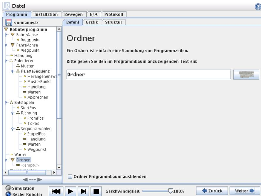
Ein Ordner wird zur Organisation und Kennzeichnung bestimmte Programmteile, zur Bereinigung des Programmbaumes und zur Vereinfachung des Lesens und Navigierens des Programms eingesetzt.
