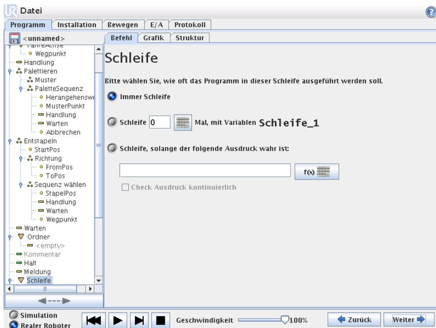
Schleifen sind zugrunde liegende Programmbefehle. In Abhängigkeit von der Auswahl werden die zugrunde liegenden Befehle entweder unbegrenzt, eine gewisse Anzahl oder solange wiederholt wie die vorgegebene Bedingung war ist. Bei der Wiederholung für eine bestimmte Anzahl wird eine fest zugeordnete Schleifenvariable (die so-genannte `loop_1` im Screenshot oben) erstellt,
