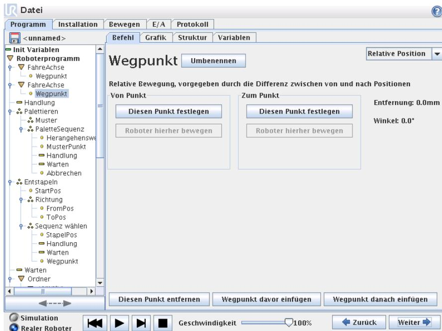
Ein Wegpunkt, dessen Position in Relation zur vorhergehenden Position des Roboters angegeben wird, wie zum Beispiel „zwei Zentimeter nach links“. Die relative Position wird als Unterschied zwischen den beiden gegebenen Positionen festgelegt (links nach rechts). Bitte beachten Sie, dass wiederholte relative Positionen den Roboter aus dessen Arbeitsbereich heraus bewegen können.
