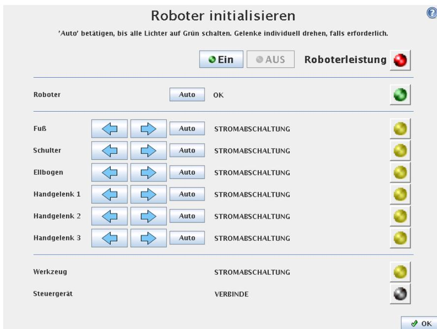
Dieser Bildschirm wird verwendet, wenn der Roboter gestartet wird. Bevor der Roboter normal arbeiten kann, muss sich jedes Gelenk ein wenig bewegen (circa 20°), um seine genaue Position zu finden. Die Schaltfläche `Auto` steuert alle Gelenke an, bis diese `OK` sind. Die Gelenke ändern die Antriebsrichtung, wenn die Schaltfläche losgelassen und erneut gedrückt wird.
