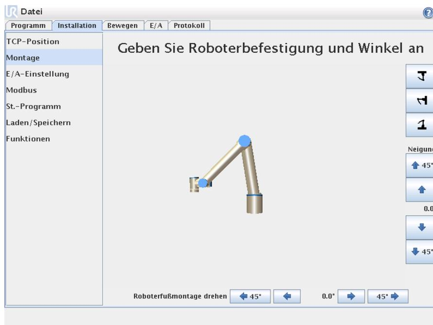
Hier kann die Montage des Roboters vorgegeben werden. Dies dient zwei Zwecken:
