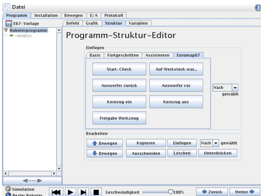
Alle Strukturen sind so konzipiert, dass eine ordnungsgemäße und sichere Interaktion mit der IMM erreicht wird, weshalb sie Tests zur Überprüfung der korrekten Einstellung bestimmter Signale umfassen. Des Weiteren können sie eventuell mehrere Ausgänge setzen, um eine Aktion auszulösen.
