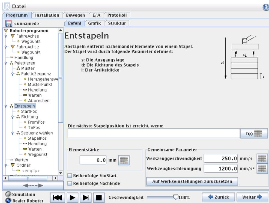
Beim Entstapeln bewegt sich der Roboter von der Ausgangsposition in die angegebene Richtung, um nach dem nächsten Element zu suchen. Wenn gefunden, merkt sich der Roboter die Position und führt die spezielle Abfolge aus. Das nächste Mal startet der Roboter die Suche aus dieser Position, erweitert mit der Dicke des Elements in der Stapelrichtung.
